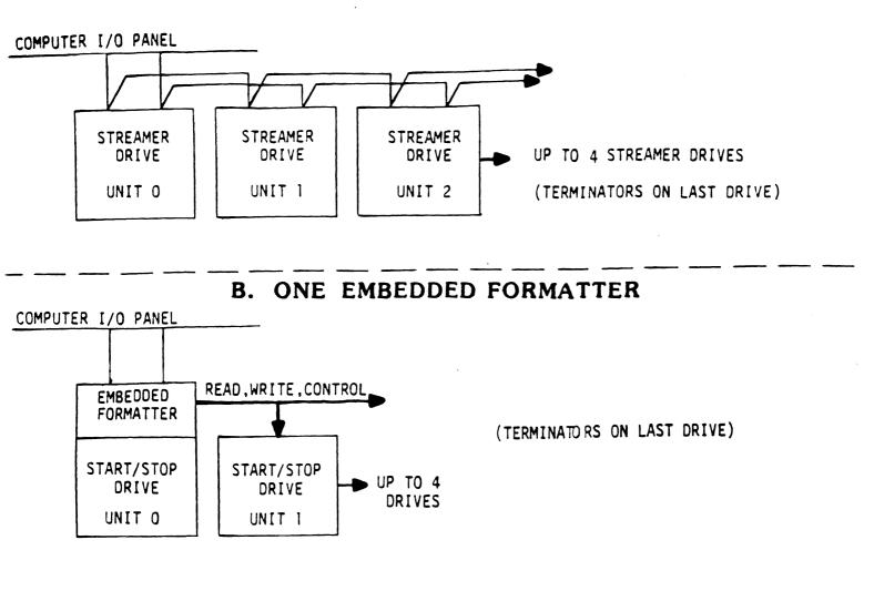
C. EMBEDDED FORMATTER AND STREAMER DRIVES
